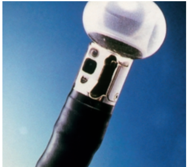
Fig. 1. Extremo distal de un ecoendoscopio radial (Olympus GF UM20). El transductor ecográfico del extremo del aparato está recubierto por un globo que se rellena con agua para conseguir una transmisión óptima de los ultrasonidos.
